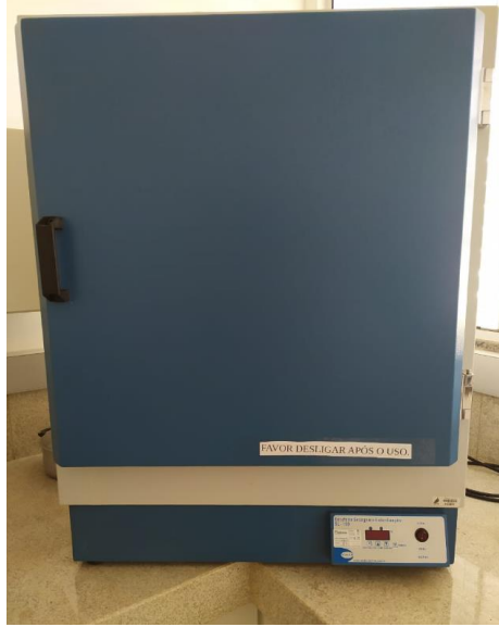
Figura 28 – Estufa de circulação forçada, utilizada para secagem das amostras dos substratos
