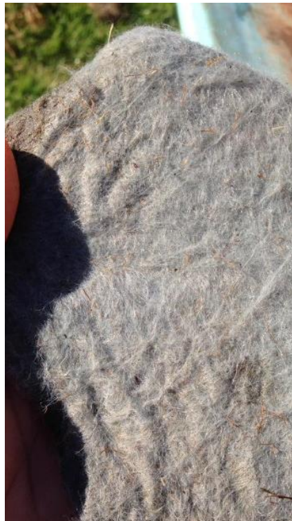
Figura 19 - Manta Geotêxtil fabricada com fibras de poliéster (PET)
