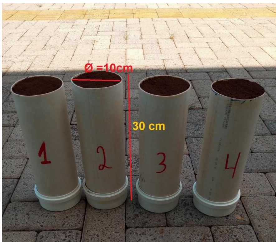
Figura 5 - Solo acondicionado em tubos de PVC, com dimensões de 30 cm de altura e 10 cm de diâmetro.
