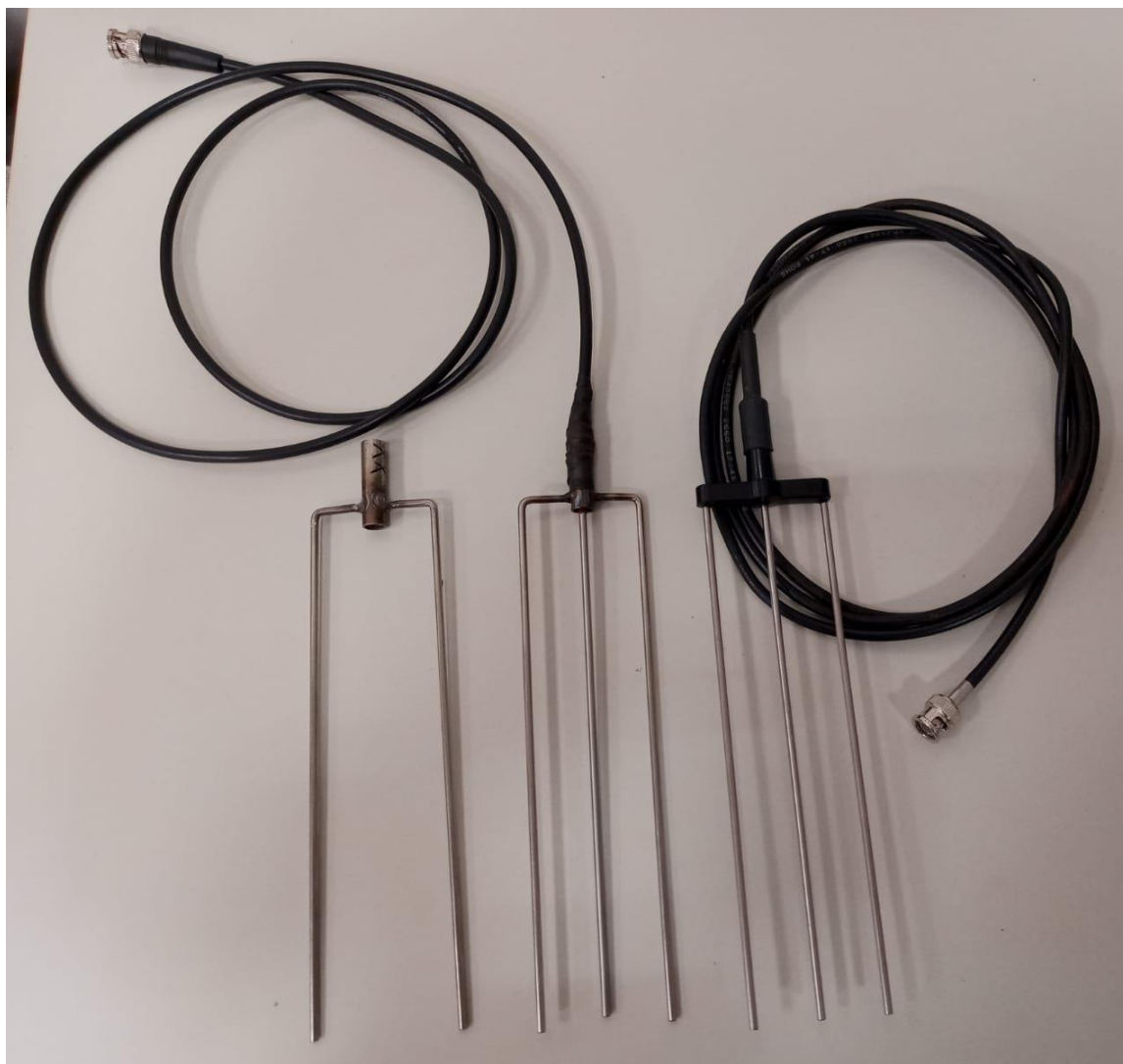
Figura 2 - Sonda artesanal em processo inicial de construção, sonda artesanal em fase final de construção e sonda original, da esquerda para direita.
