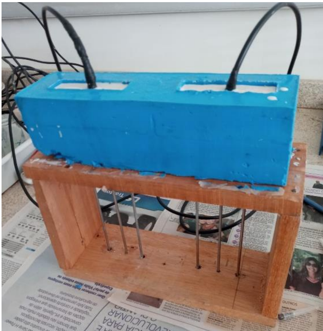
Figura 3 - Processo de fabricação da Sonda Artesanal, na qual a mesma se encontra no molde de silicone, com resina isoftálica aguardando secagem.
