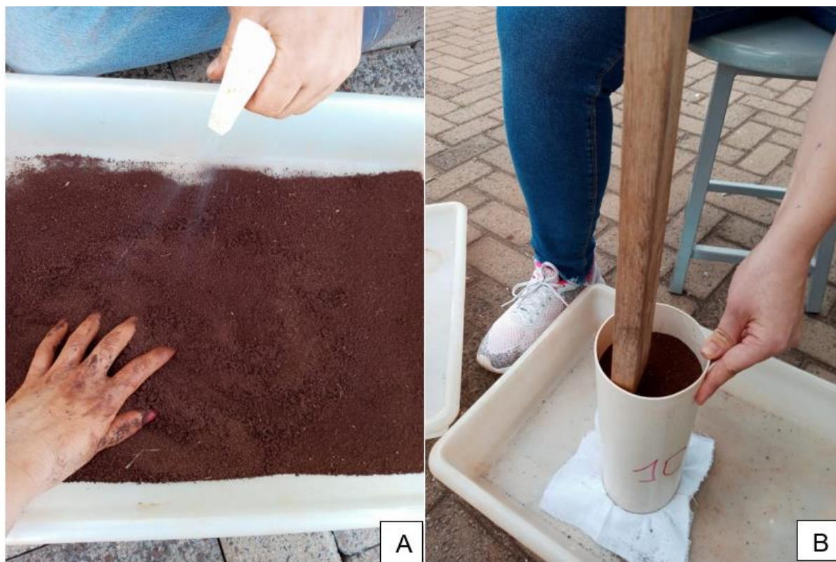
Figura 8 - Acréscimo de água no solo (A- homogeneização do solo com acréscimo de água; B- montagem dos cilindros com o solo).
