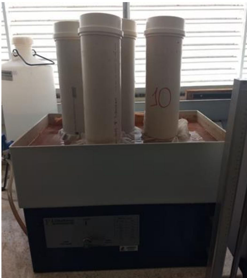
Figura 7 - Solo na mesa de tensão para determinação da condição de umidade na capacidade de campo.
