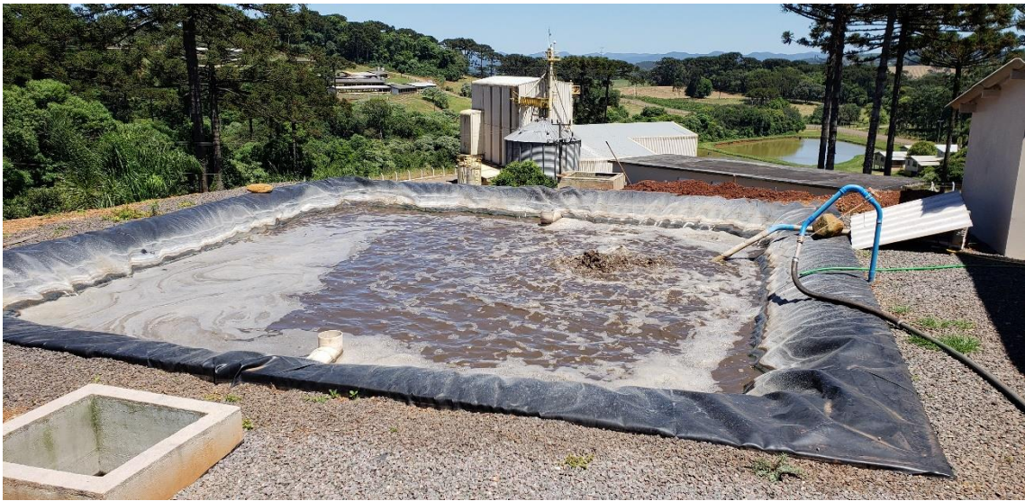
Figura 20 – Local de armazenamento do lodo nitrificante para segunda partida de reator nitrificante
