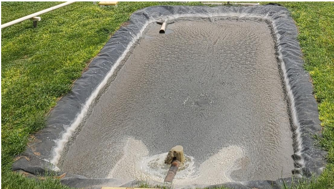
Figura 6 – Decantador 1, segunda operação unitária da etapa de SSL do Módulo Bio
