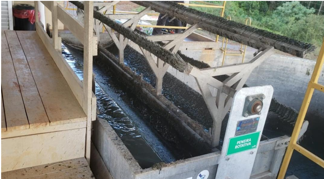
Figura 5 – Peneira com escovas rotativas com crivos de 2 mm, primeira operação unitária da etapa de SSL do Módulo Bio
