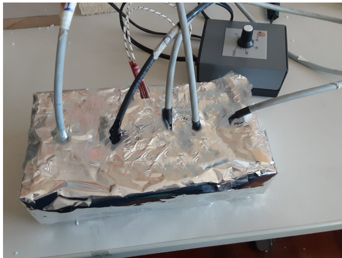
Figura 12 - Isolamento da placa com isomanta
