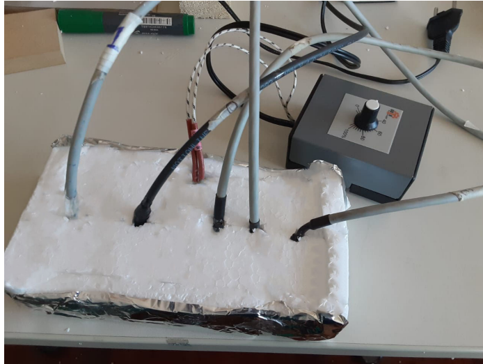
Figura 11 - Isolamento da placa com isopor
