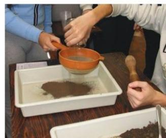
Figura 3. Moagem e peneiramento da amostra de solo seca ao ar.
