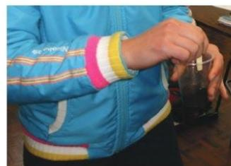
Figura 4. Agitação ocasional da mistura de solo e solução de  $\text{CaCl}_2$  0,01 mol/L.
