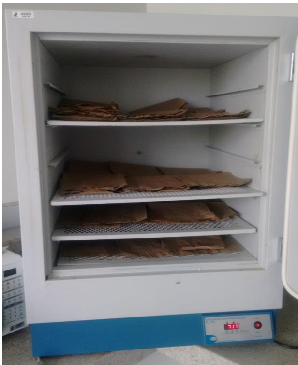
Fotografia 2 - Estufa de circulação de ar forçada.
