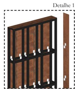
Estruturação das placas de aço corten em malha de metalon. Sistema de encaixe das placas, que depois levam também um cordão de solda nas arestas do volume.
