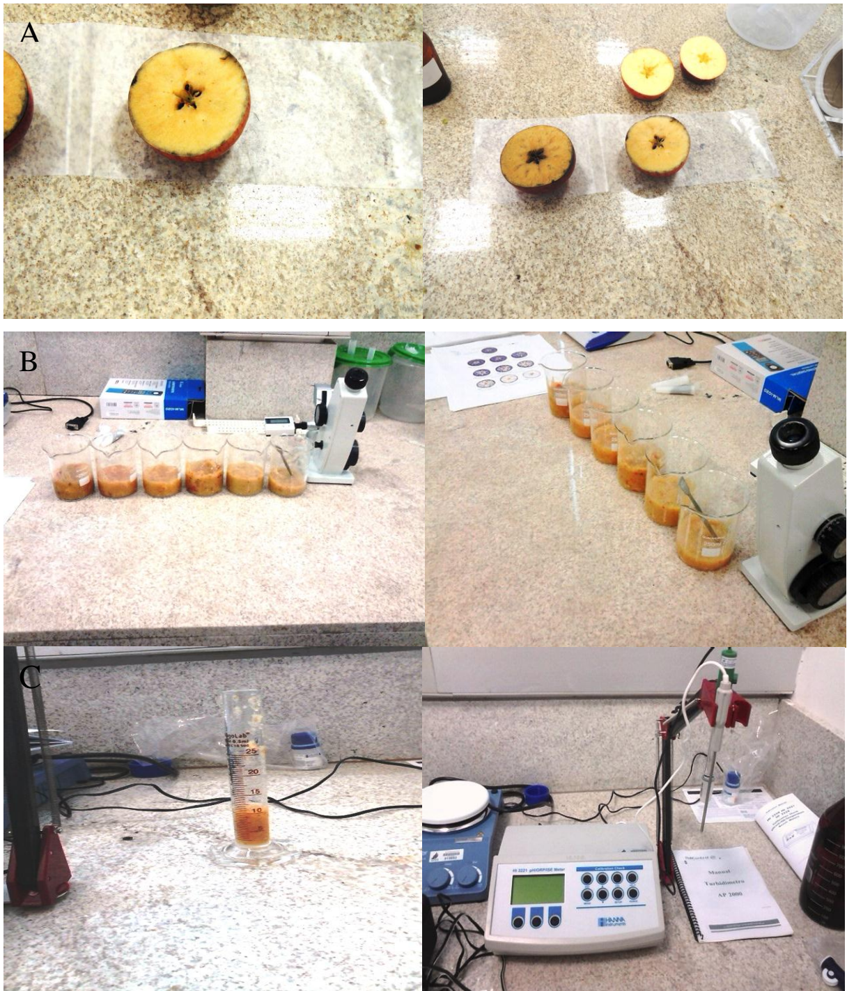
Fotografia 5 - A: Índice de Iodo-amido, B: Sólidos Solúveis Totais e C: Acidez Titulável. Laranjeiras do sul, PR.
