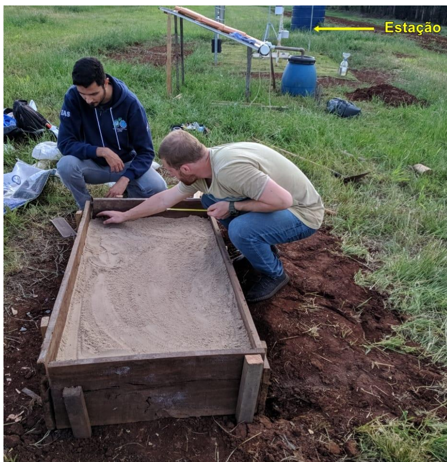
Figura 4 – Local de execução do modelo de pavimento permeável e ao fundo a Estação Pluviométrica.
