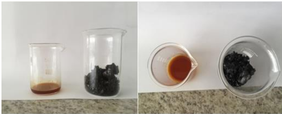
Figura 11: Amostra da Pirólise Fração Líquida e Sólida produzido no teste com temperatura 650°C
