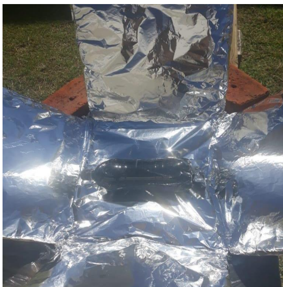
Figura 21 - Sistema de desinfecção
