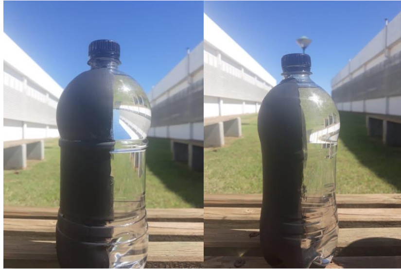
Figura 22 - Deformação da garrafa PET no processo de desinfecção
