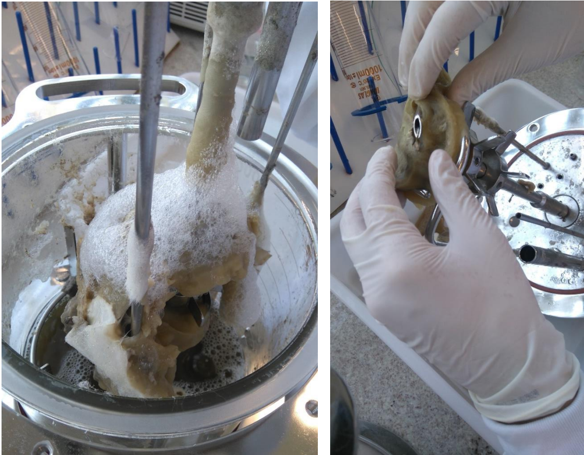
Figura 7 – Desenvolvimento do fungo T. koningiopsis entrelaçado nas pás do rotor do biorreator após fermentação de 120 horas.
