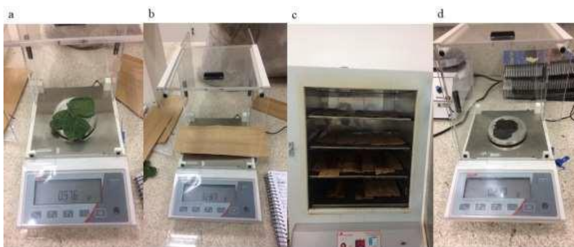
Figura 5 - Processo das avaliações da matéria fresca e seca dos trifólios dos morangueiros
