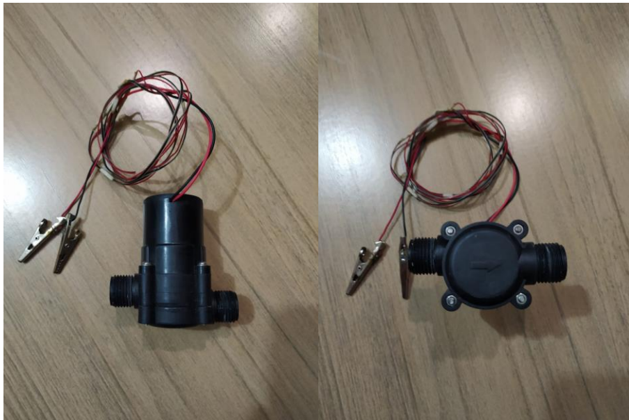
Figura 28 - Gerador hidráulico do protótipo.
