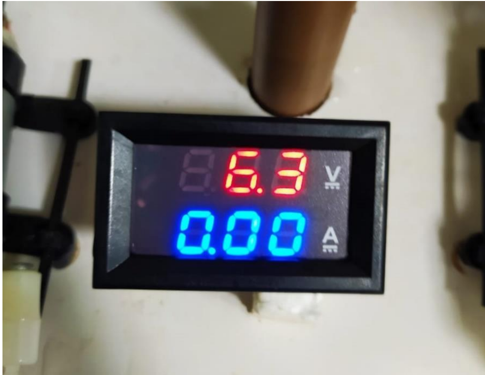
Figura 31 - Modelo de voltímetro do sistema de geração
