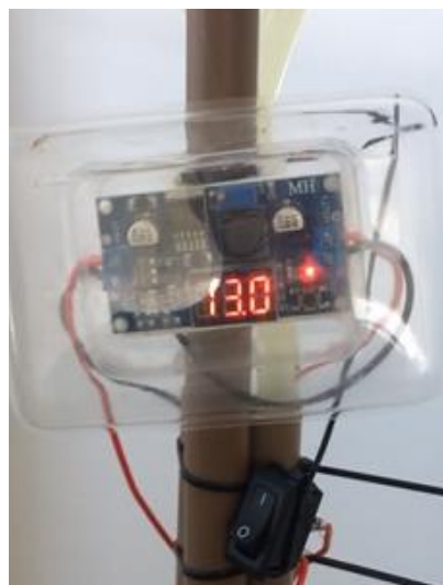
Figura 37 - Regulador de tensão em funcionamento
