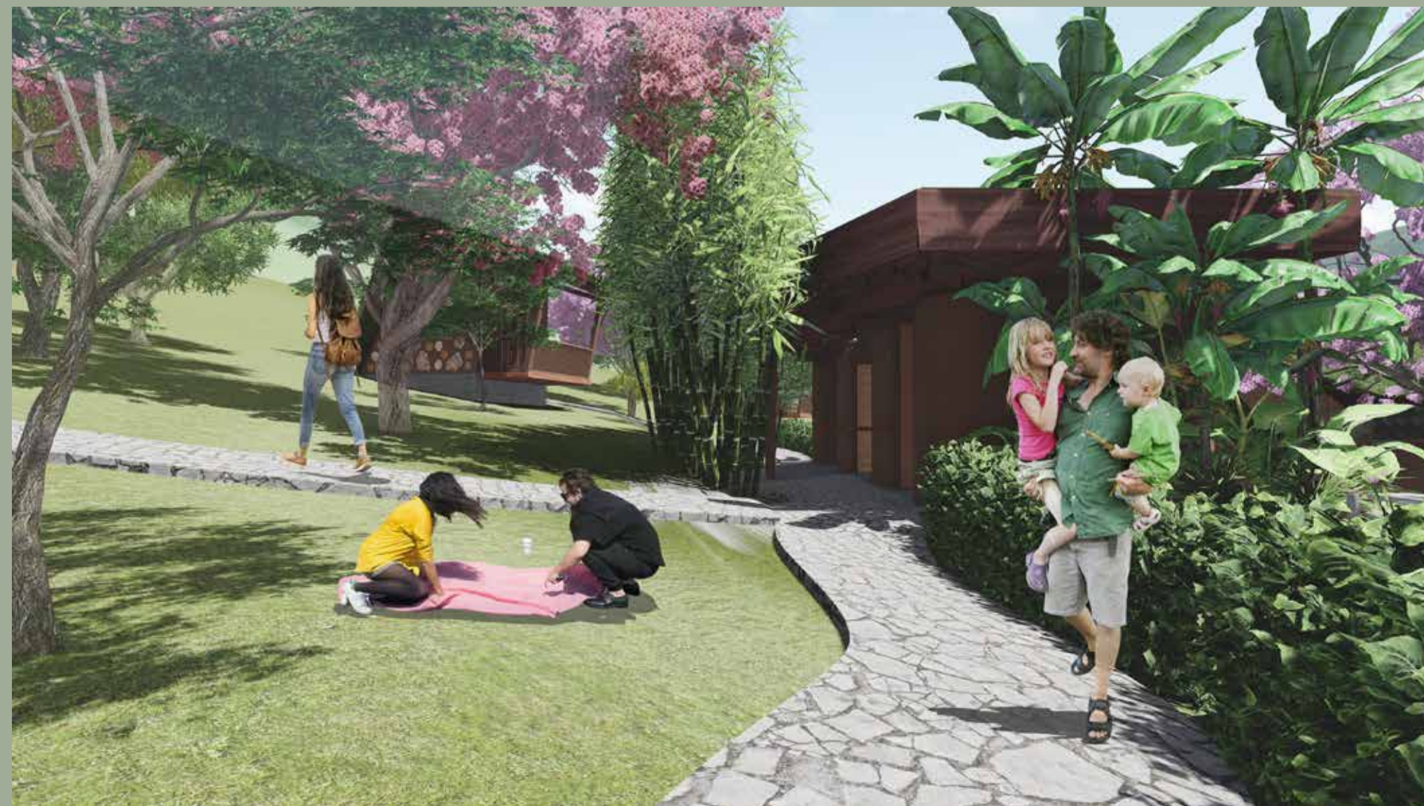
6 A perspectiva 6 é direcionada para um dos conjuntos de banheiros, edificação esta que é desenvolvida com hiperadobe na base (proporcionando paredes curvas) e quinha na parte superior.
