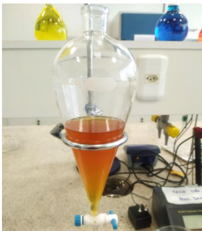
Figura 7 – Lavagem do meio reacional com heptano
