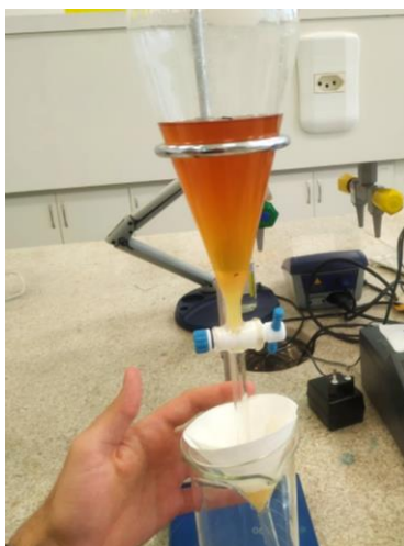
Figura 8 – Filtração da solução presente no funil de decantação
