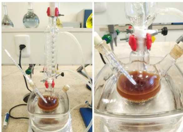
Figura 4 – Aparato experimental utilizado nas reações de transesterificação
