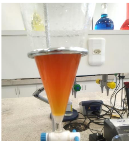
Figura 6 – Lavagem do meio reacional com solução saturada de NaCl
