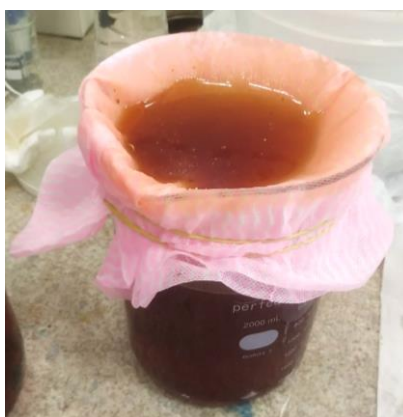
Figura 2 – Filtragem do óleo residual de algodão
