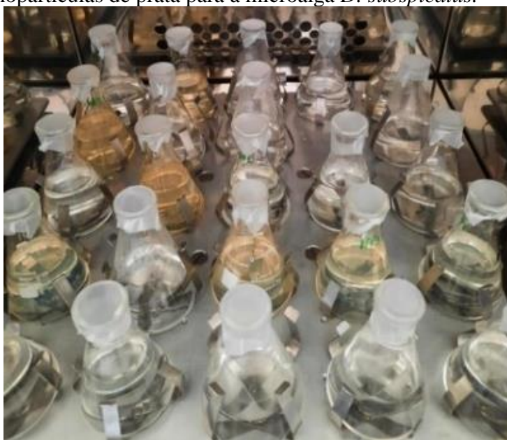
Figura 5 – Disposição dos erlenmeyers em shaker incubadora para teste crônico com nanopartículas de prata para a microalga D. subspicatus .
