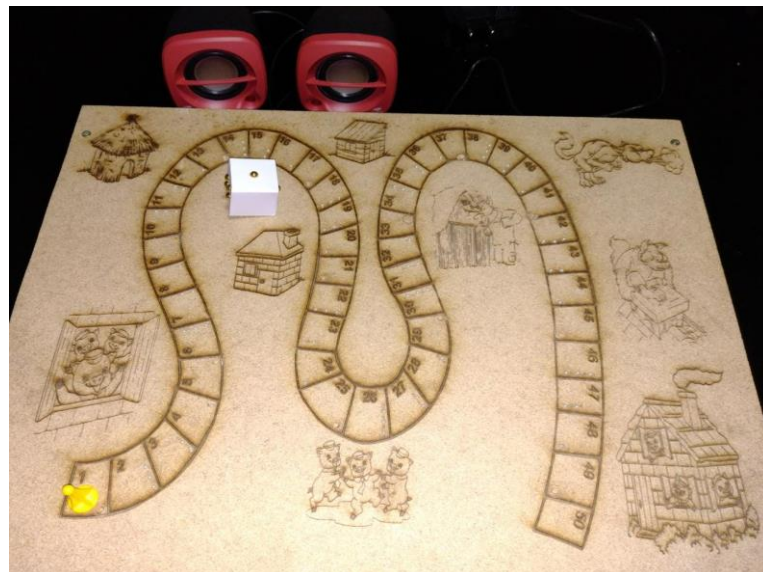
Fotografia 12 - Trilha usinada em CNC
