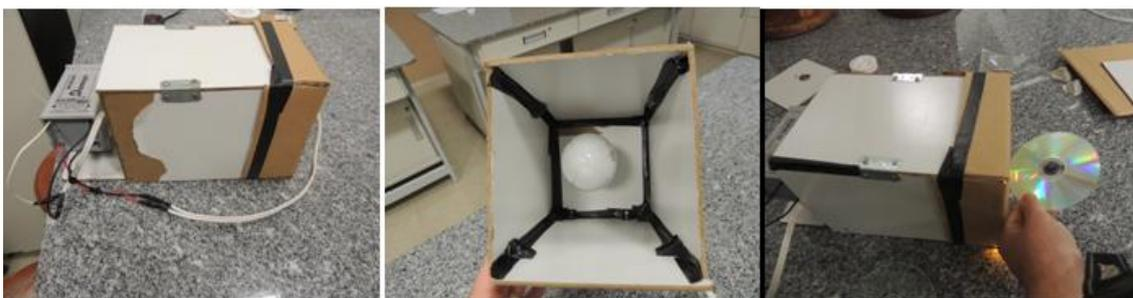
Figura 4: Imagens do espectroscópio caseiro
