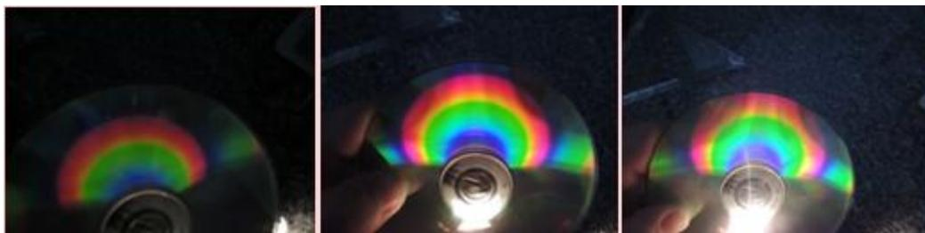
Figura 5: Imagens de espectro de uma lâmpada incandescente de Tungstênio.
