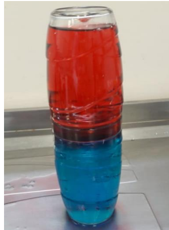
FIGURA 4 – EXPERIMENTO EM FUNCIONAMENTO, COM ÁGUA QUENTE EM CIMA E ÁGUA FRIA EM BAIXO.
