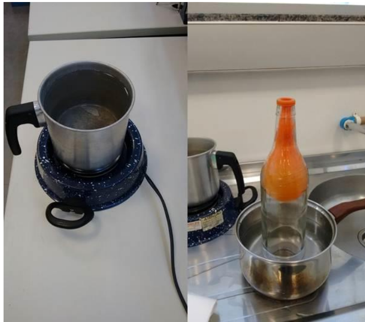
FIGURA 2 - EXPERIMENTO “BEXIGA NA GARRAFA”. À DIREITA, A ÁGUA SENDO AQUECIDA; À ESQUERDA, A GARRAFA EM UM RECIPIENTE COM ÁGUA FRIA.
