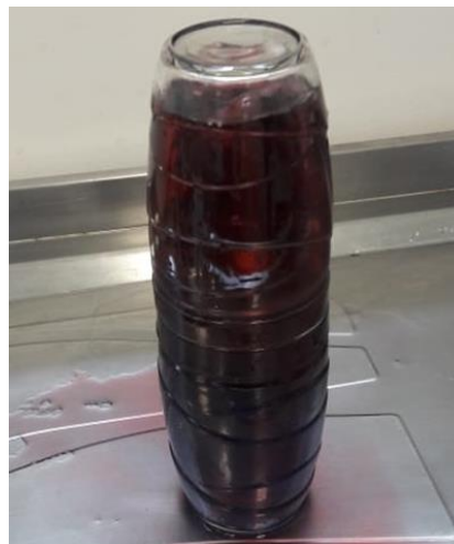
FIGURA 5 – RESULTADO EXPERIMENTAL COM A ORDEM DE POSIÇÃO ENTRE OS LÍQUIDOS QUENTE E FRIO INVERTIDA: ÁGUA QUENTE EM BAIXO E ÁGUA FRIA EM CIMA, OCACIONADO A MISTURA ENTRE ELAS.
