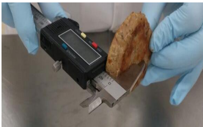
Figura 9 - Determinação da espessura do fishburger.
