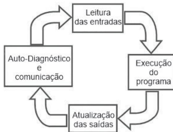
Figura 3 – Representação de um ciclo de scan contínuo Fonte: DEY e SEN (2020)
