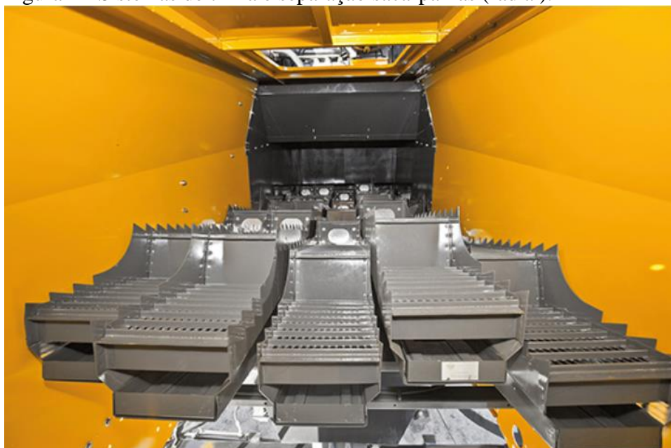
Figura 1 - Sistemas de trilha e separação saca-palhas (radial).
