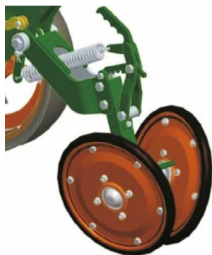
Figura 2 - Mecanismo de adensamento com centro aberto.
