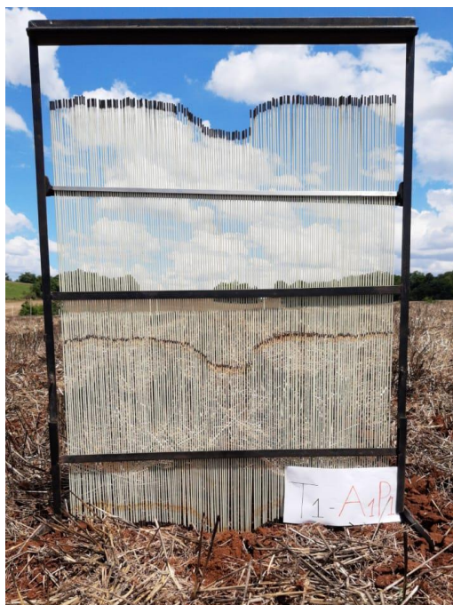
Figura 7 - Perfilômetro utilizado na linha de semeadura.
