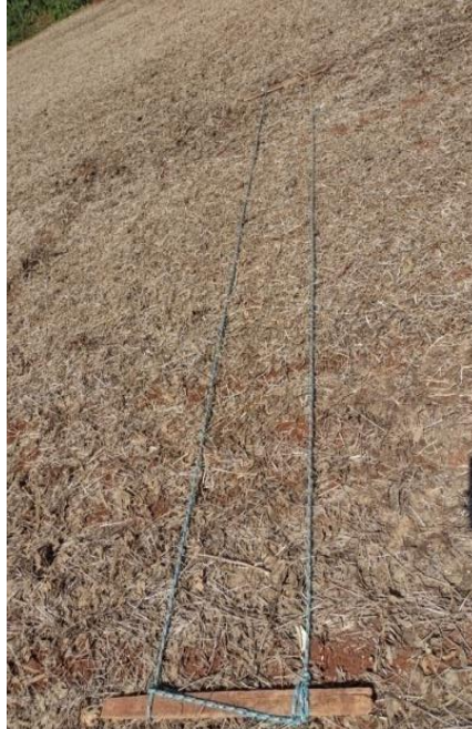
Figura 11 - Área de 2 m 2 utilizada para coleta das amostras de perdas de grãos segundo metodologia prevista, Cândido Godói, 2021
