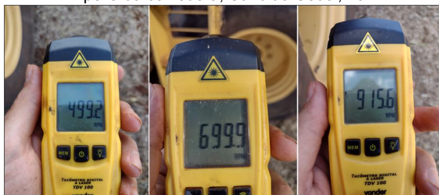
Figura 8 - Medições do Tacômetro das rotações do ventilador (rpm) do sistema de limpeza da colhedora, Cândido Godói, 2021
