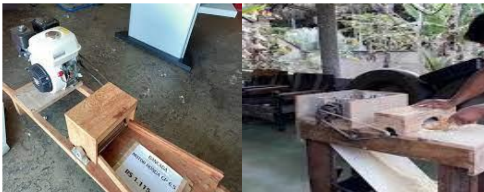
Figura 44 - Motor utilizado para sevar (triturar, moer) a raiz da mandioca.
