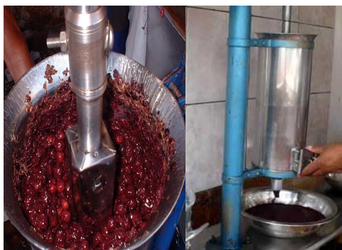
Figura 50 - Preparo do vinho(polpa) de açaí utilizando a despulpadeira elétrica
