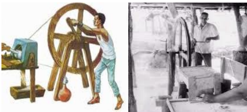
Figura 43 - Rodete juntamente com o ralador para moer ou ralar as raízes de mandioca.
