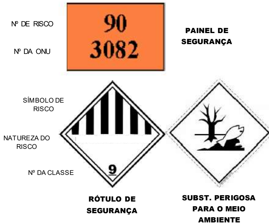
Figura 9 - Localização correta das placas de sinalização do produto transportado no veículo.
