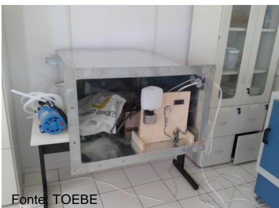
Fotografia 5. Psicrômetro já montado no interior da minicâmara.
