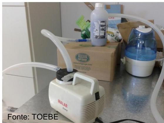
Fotografia 2. Sistema de desumidificação (bomba de membrana, tubos e reservatório com sílica gel).
