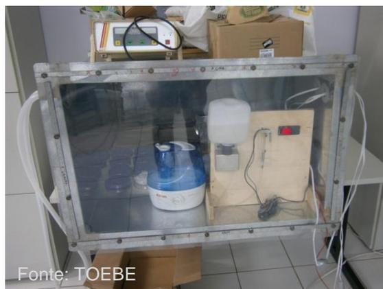
Fotografia 4. Sistema de desumidificação e umidificação em fase de testes.
