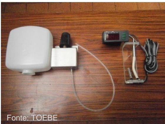
Fotografia 1. Psicrômetro eletrônico da marca Full Gauge.
