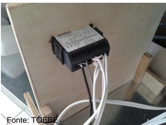
Fotografia 3. Fios que alimentam os sistemas de desumidificação e umidificação da minicâmara.
