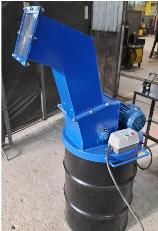
Figura 14 – Triturador de vidro da COOPERVIDA-RS
