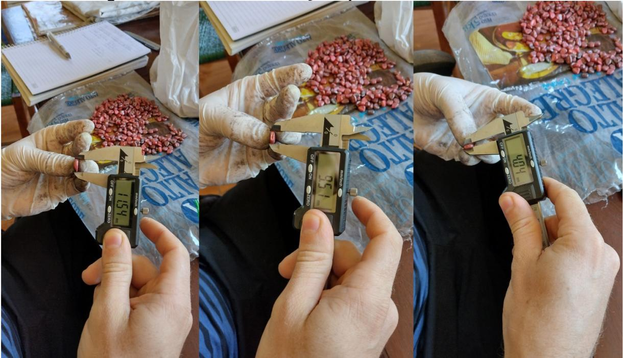
Medição das sementes quanto sua altura, largura e espessura com auxílio de paquímetro digital.
