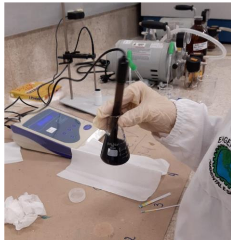
Figura 10 – Medição do pH para as amostras do teste de dosagem.
