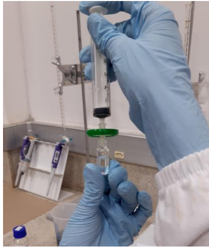
Figura 13 - Filtração por membrana e disposição em vials.
