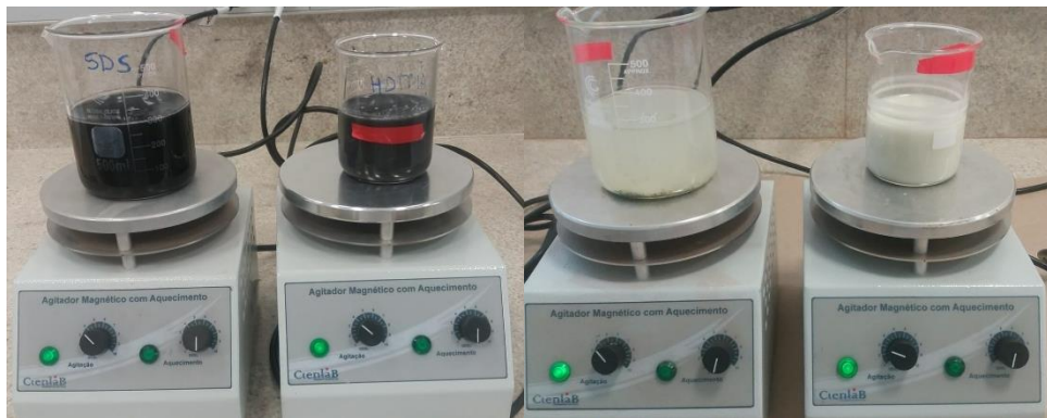
Figura 14 – Soluções da funcionalização com surfactantes dos materiais adsorventes em agitação.
