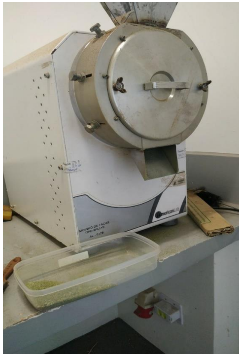
Figura 2 - Moinho de facas tipo Willey utilizado para moagem de folhas e grãos
