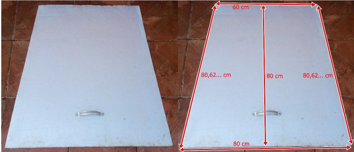
Figura 58 - Tampa da cisterna
