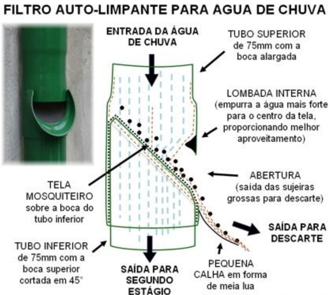
Figura 4 - Filtro autolimpante
