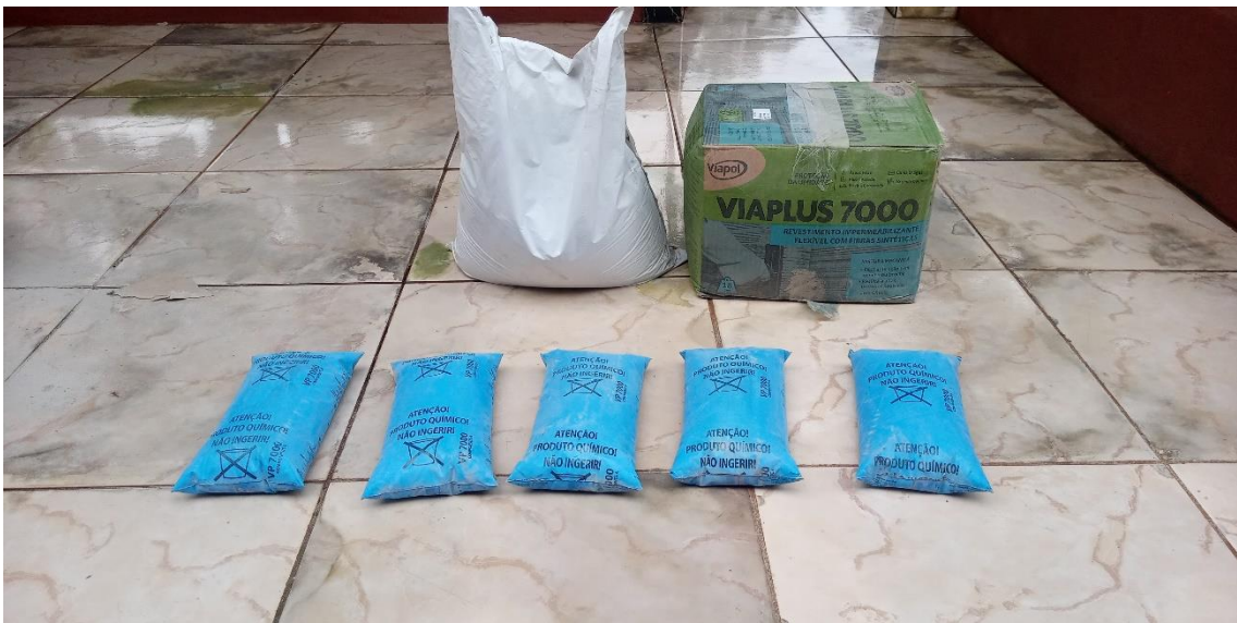
Figura 49 - Impermeabilizante utilizado para aplicação interna da cisterna
