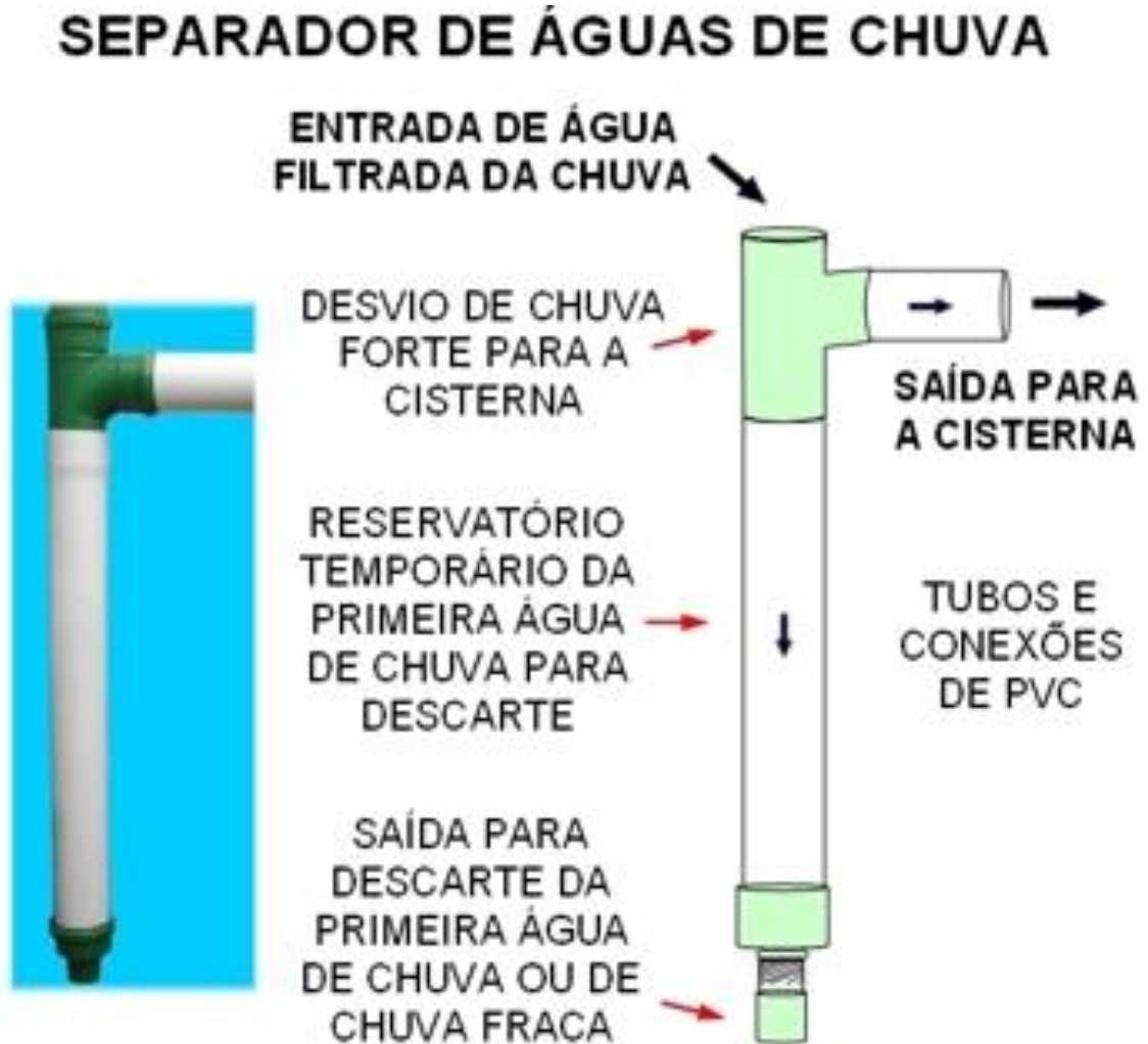
Figura 5 - Modelo de desvio de água suja ou chuva fraca
