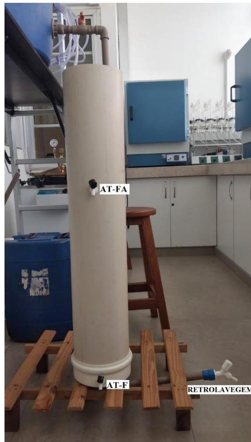
Nota: Leito Filtrante/Adsorvente tem a altura de 1,05 m, e pontos de coleta de água do RLF-BF, água tratada por filtração (AT-F), água tratada por filtração e adsorção (AT-FA), e inserção de água para retrolavagem através da torneira nomeada como RETROLAVAGEM. Fonte: Autora (2022).
