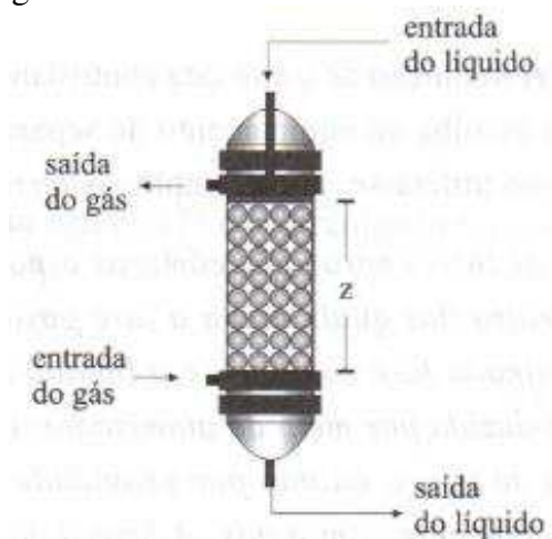
Figura 2 – Torre de recheio
