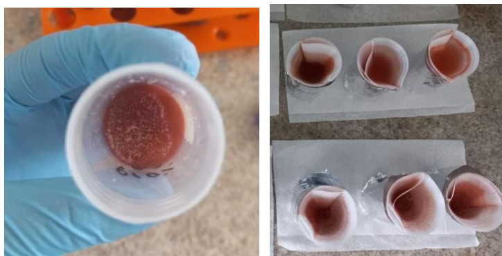
Figura 3 – Ensaio do efeito competitivo de PE na adsorção de CIPRO em óxido de Fe sintético
