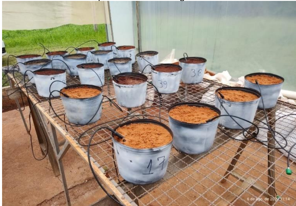
Figura 5 - Vasos com sonda de TDR instaladas para o monitoramento da água no solo para a cultura do trigo.
