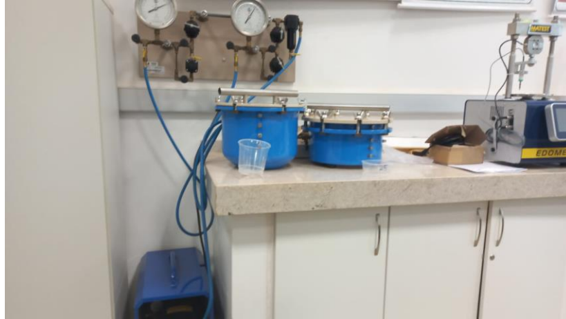
Figura 12 - Câmara de Richards utilizada no experimento para a determinação da umidade em potencial matricial de -1500 kPa
