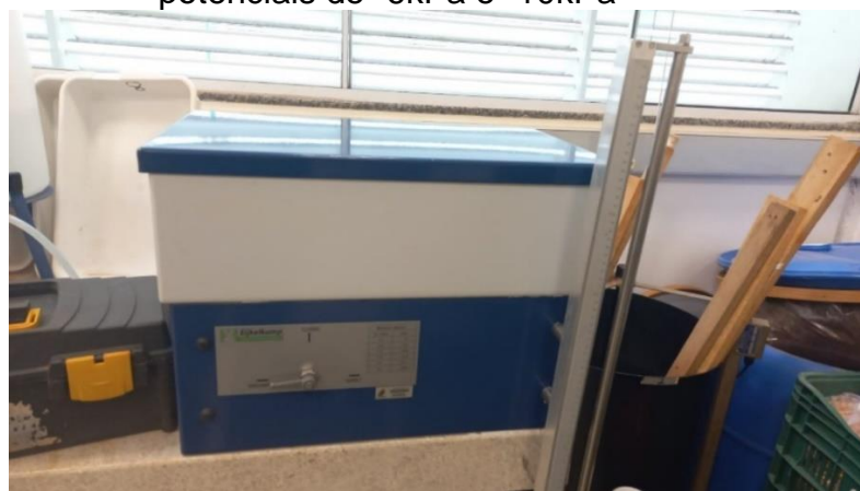
Figura 11 - Mesa de tensão utilizada no experimento para determinar a umidade nos potenciais de -6kPa e -10kPa
