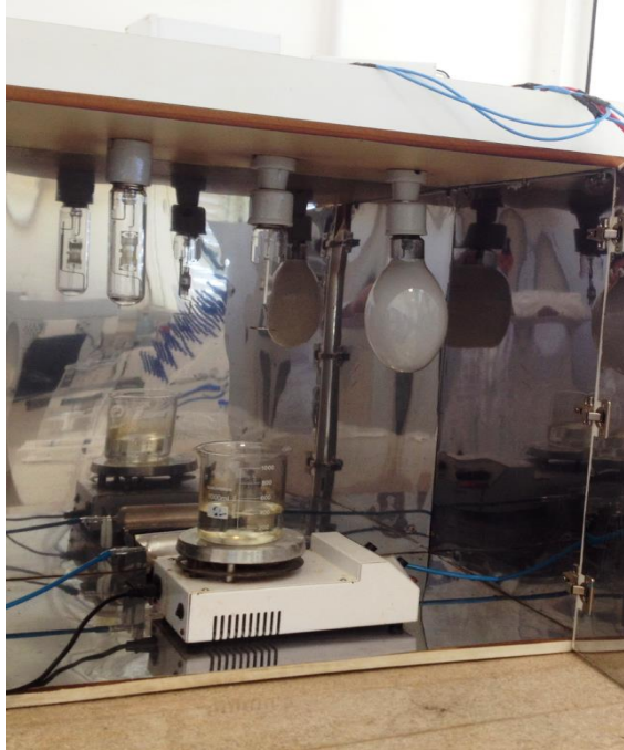
Figura 3.1. Módulo do sistema de irradiação UV- vis .
