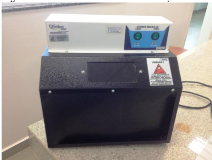
Figura 3.2. Módulo do sistema de irradiação UV-A e UV-C.
