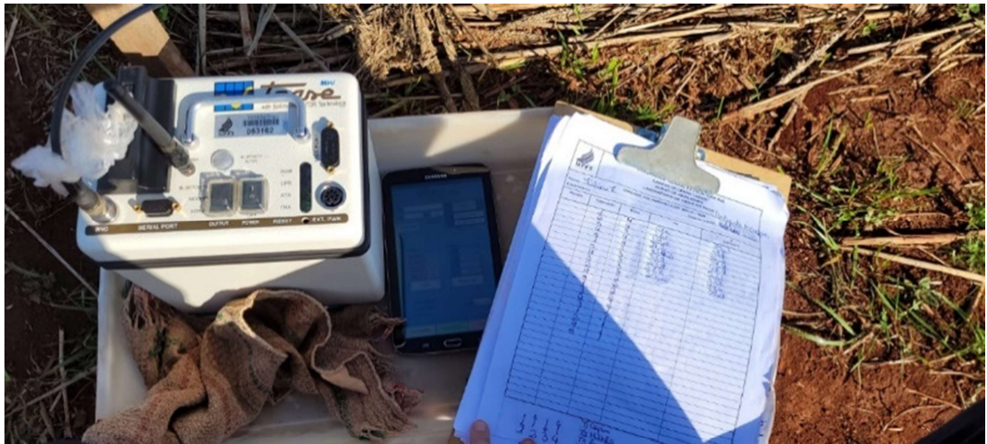
Figura 17 - Coleta de dados através do TDR, na área experimental da Universidade Federal da Fronteira Sul – campus Cerro Largo, 2022.
