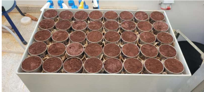
Figura 15 – Método da Mesa de Tensão, no Laboratório de Física e Pedologia do Solo da Universidade Federal da Fronteira Sul – campus Cerro Largo, 2023.
