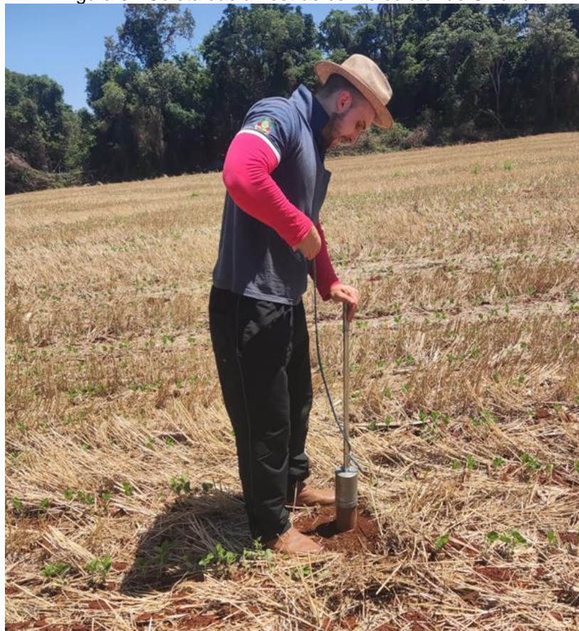
Figura 3 - Coleta das amostras com o coletor de Uhland
