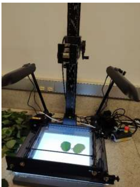
Figura 2- Sistema de análise de imagem de folha WinDIAS 3
