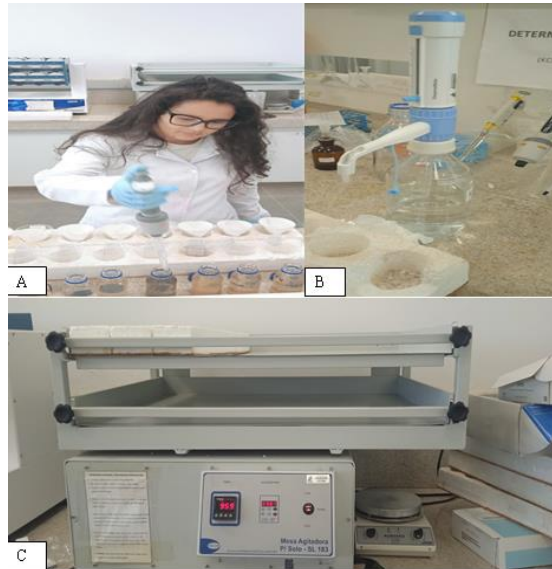
Figura 11. Coleta e transferência da alíquota da amostra de água para copos plásticos (A). Adição de KCl 1N nas amostras de água (B). Agitação das amostras em mesa agitador horizontal (C). Fonte: Elaborado pela autora, 2022.
