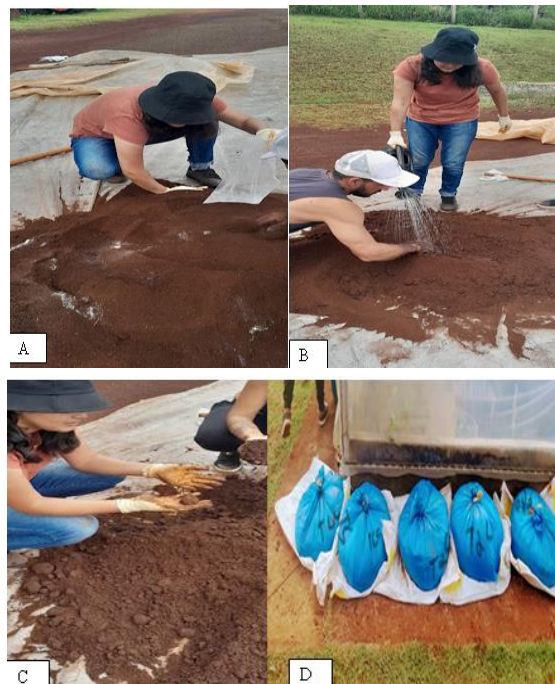
Figura 5. Aplicação dos corretivos (A). Mistura dos corretivos com água no solo (B). Teste para verificar o ponto de umidade para incubação do solo(C). Incubação do solo (D). Fonte: elaborado pela autora (2022).
