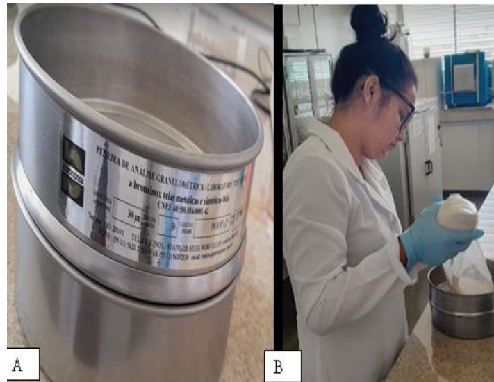
Figura 4. Peneira nº 50 ABNT (malha 300 \mu\text{m} ) utilizada na padronização granulométrica dos corretivos testados (A). Tamisagem dos corretivos utilizados na calagem do solo ácido (B). Fonte: elaborado pela autora (2022).
