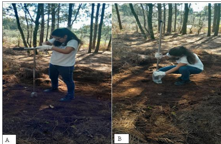
Figura 2. Trado Holandês para a coleta do solo (A). Embalagem do solo para enviar ao laboratório (B). Fonte: Elaborado pela autora (2022).
