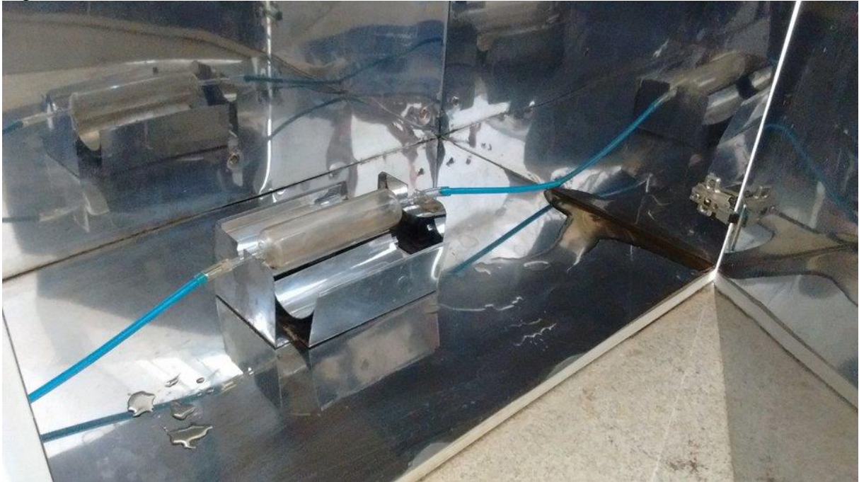
Figura 3 – Caixa aberta com o reator de vidro Schott-Durán.
