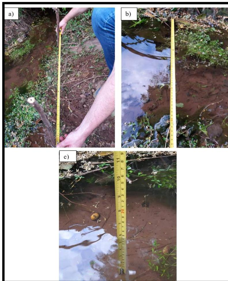
a) Determinação da distância do ponto inicial até o ponto final; b) Medida da largura de uma margem a outra do corpo hídrico; c) Medida da altura da lâmina d'água em vários intervalos. Fonte: Elaborado pelo autor (2022).
