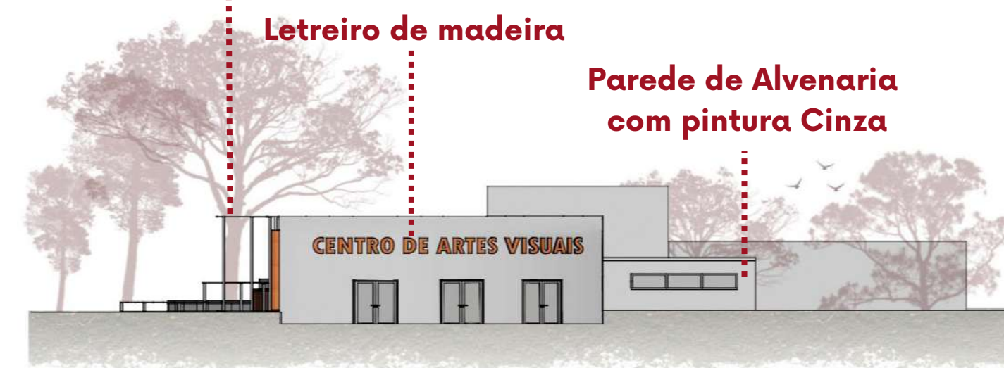
FACHADA SUL BLOCO A esc. 1:250
