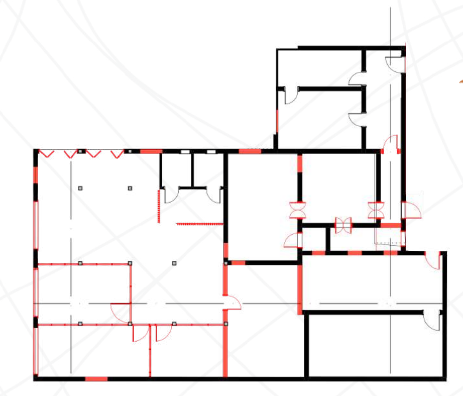
7 PLANTA DEMOLIR SUBSOLO 1:200
