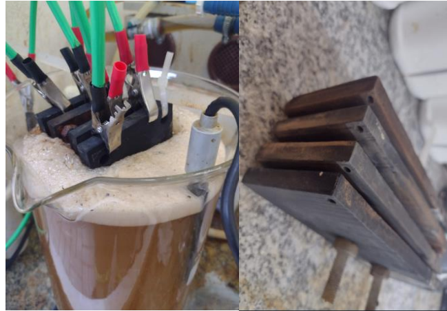
Figura 3 - Aparato utilizado para realização dos testes com eletrodos de grafite
