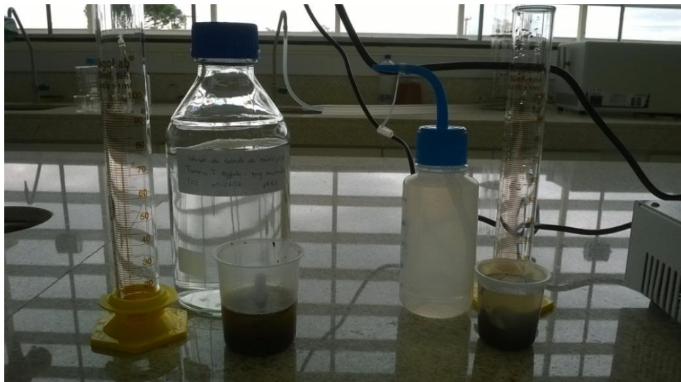
Figura 10 - Duas amostras de resíduos, uma contendo água destilada e a outra contendo a solução de \text{CaCl}_2 . Fonte: Elaborado pelo autor.
