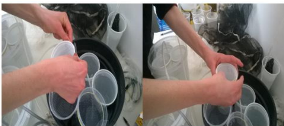
Figura 2. Montagem do Sistema para o ensaio de CL 50
