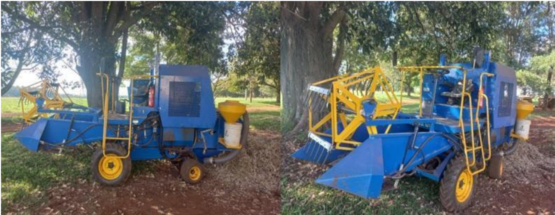
Figura 3 - Debulhadora de parcelas experimentais Semina 1400.
