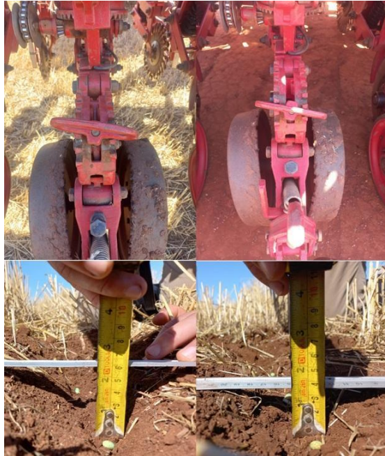
Figura 2 - Ajuste dos limitadores de profundidade de semente, 6 cm de profundidade (esquerda) e 3,5 cm de profundidade (direita).
